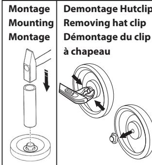
**D:** Montage/Demontage Hutclip: Der Hutclip lässt sich mit einer Zange abziehen.
